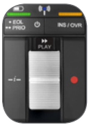
Bouton à glissière : Avance rapide, lecture / enregistrer, stop, retour rapide (LFH3020)
